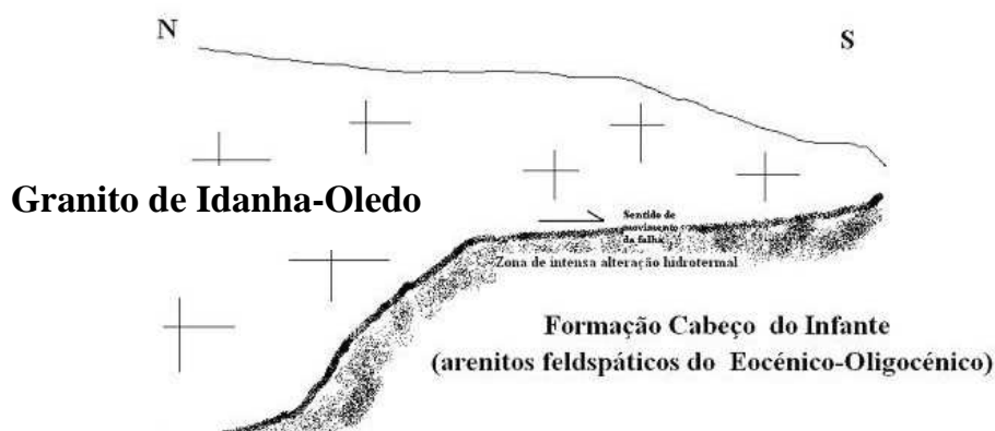
Figura 4 – A reactivação Bética (fini-miocénica) da Falha do Ponsul, segundo um movimento inverso, leva à sobreposição das fácies do Granito de Idanha-Oledo, de idade Ordovícico Inferior (490-480 milhões de anos), em relação às arcoses cenozóicas (Formação de Cabeço do Infante: 50-30 milhões de anos). A zona de falha apresenta-se esbranquiçada pela intensa alteração hidrotermal numa faixa com 2m de espessura, que também levou à recristalização do granito e ao endurecimento dos sedimentos cenozóicos.
